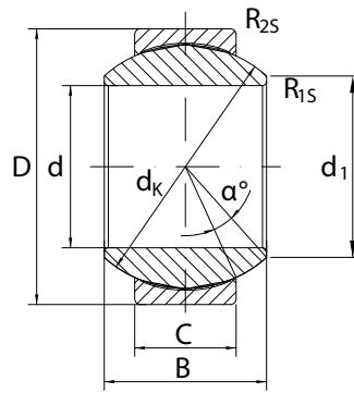
Underhållsfritt ledlager med ytterring av stål där glidytan är belagd med PTFE. Innerring är hårdförförkromat stål. Bredare innerring och större ytterdiameter.
